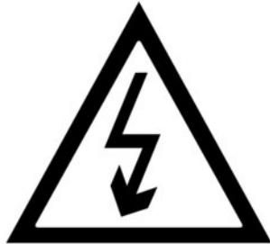
Simbol **A** označava električne elemente na vozilu koji mogu uzrokovati ozljede.
