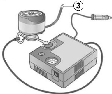
Kada je guma pravilno napuhana, uklonite komplet: polako odvijte nastavak za napuhavanje spremnika **3** da biste sprječili prolijevanje sredstva i pohranite spremnik u plastično pakiranje da biste sprječili curenje proizvoda.
