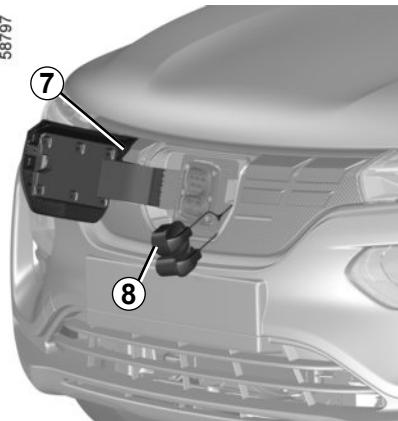
Ne vozite automobil s poklopcom za punjenje **7** otvorenim. Nakon što je kabel za punjenje isključen iz vozila, provjerite je li poklopac **8** vraćen i jesu li vratašca za punjenje **7** pravilno zatvorena.
