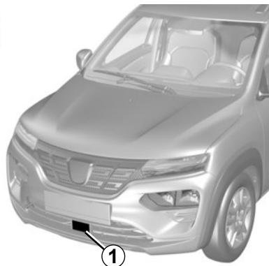
Na temelju podataka radara **1** sustav izračunava udaljenost u odnosu na vozilo ispred.
