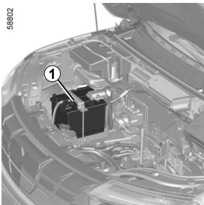
Pomoći akumulator je akumulator od 12 V: on dobavlja električnu energiju za rad opreme vozila (svjetla, brisači vjetrobranskog stakla, zvučni sustav, itd.) i određenih sigurnosnih sustava, kao što je ABS.
