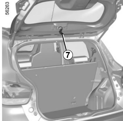
Otkrenite nosač žarulje **7** za četvrtinu okretaja, izvucite ga i skinite žarulju.
