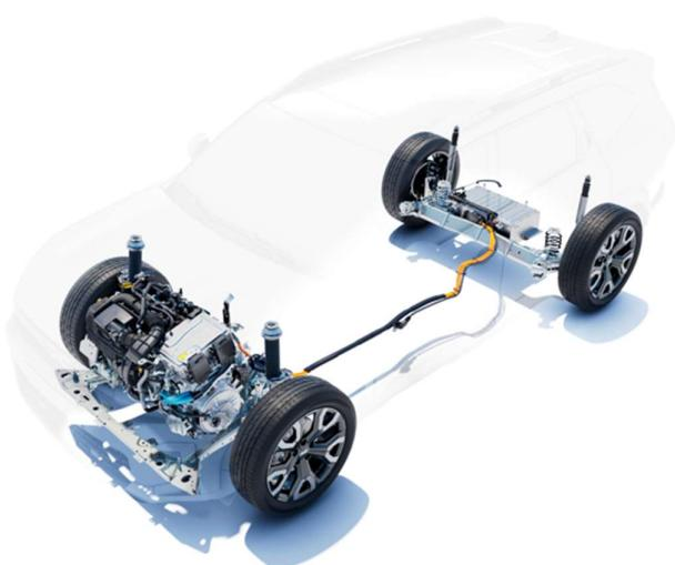
**Bigster mild hybrid 140.** Motor snage 140 KS temelji se na motoru TCe 130 za Duster te je još jedna novost u ponudi marke Dacia. Riječ je pogonu s prvom razinom elektrifikacije koji uključuje 1,2-litreni trocilindarski benzinski turbomotor nove generacije koji upotrebljava Millerov ciklus (veća učinkovitost i manji gubici pumpe), blagi hibrid od 48 V i 6-stupanjski ručni mjenjač.
