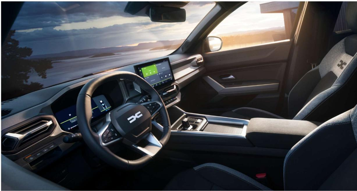
Radi veće jednostavnosti i učinkovitosti, informacije o vožnji objedinjene su na 7-inčnom ili 10-inčnom digitalnom zaslonu instrumentne ploče (ovisno o inačici), dok se informacije vezane uz multimedijski sustav prikazuju na 10,1-inčnom središnjem dodirnom zaslonu (serijski u svim inačicama Bigstera). Između tih dvaju zaslona proteže se elegantna zelena linija koja ih povezuje u cjelinu s armaturnom pločom.
