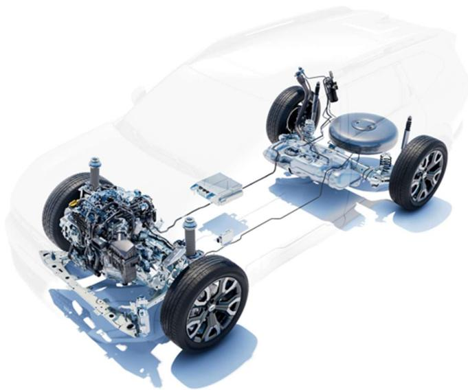
**Bigster mild hybrid 130 4x4.** Bigster je stvoren za pustolovine izvan utabanih staza, a da bi u njima bio što učinkovitiji, pomažu mu pogon na sve kotače, 6-stupanjski ručni mjenjač i blagi hibrid od 48 V. Hibridni sustav pomaže 1,2-litrenom trocilindarskom turbomotoru u fazama pokretanja i ubrzanja, smanjuje potrošnju goriva i emisije CO<sub>2</sub> te povećava užitak u vožnji. Povrh toga, regenerativno kočenje puni bateriju od 0,8 kWh, a da vozač to ni ne primijeti.
